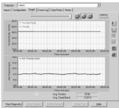
图 4. 阀门摩擦力和死区分析
